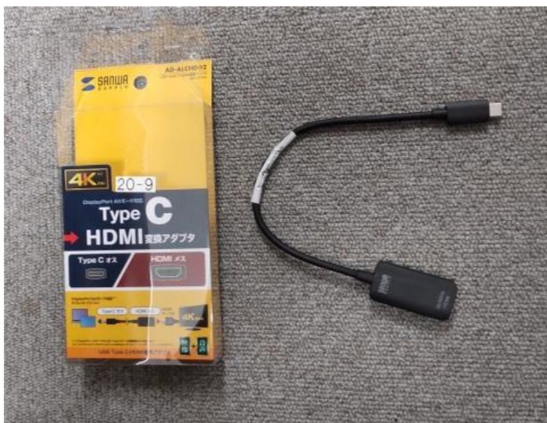
※ TYPE-C の出力を持つ Android 端末等が、HDMI 端子搭載機器へと接続した際に、その Android 端末等が映像出力が可能であることが条件となります。
